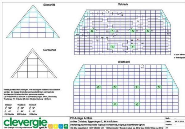
Figure 80: Glaserhaus Affoltern im Emmental (CH). Photovoltaic roof plan, © Clevergie
